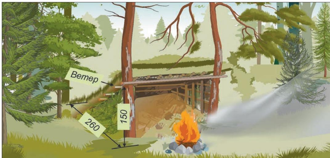
Рис. 43. Односторонний заслон-навес (6 человек устанавливают за 2—3 часа).
