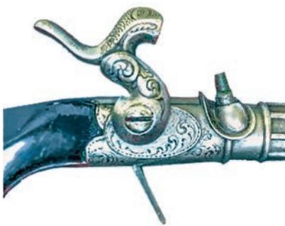
Рис. 26. Ударно-капсюльный замок
