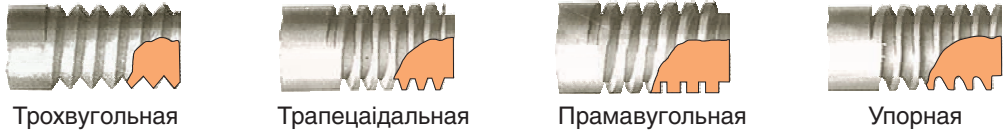
Рыс. 86. Віды разьбы па профілю
