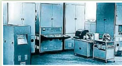
ЭВМ «Минск-1» в первой половине 1960-х гг. — лидирующий тип серийных ламповых машин такого типа в СССР
