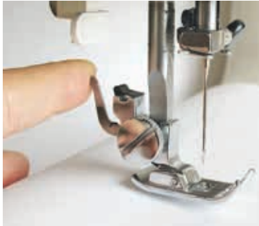
Мал. 73. Паслядоўнасць усталявання лапкі
