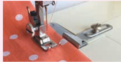
Мал. 69. Абмежавальная лінейка (а), замацаванне складкі (б)
