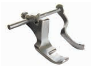
Мал. 68. Лапка з накіравальнай лінейкай (а), выкананне прашыўкі (б)
