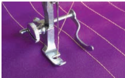
Мал. 68. Лапка з накіравальнай лінейкай (а), выкананне прашыўкі (б)
