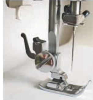
Мал. 73. Паслядоўнасць усталявання лапкі
