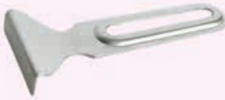
Мал. 69. Абмежавальная лінейка (а), замацаванне складкі (б)
